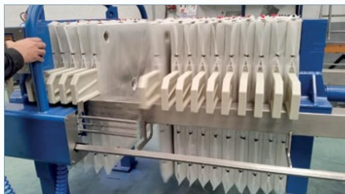
**Sistema auxiliar para la ayuda en el traslado de placas de polipropileno.** Está formado por un carro de traslado y un conjunto de cilindros neumáticos.
